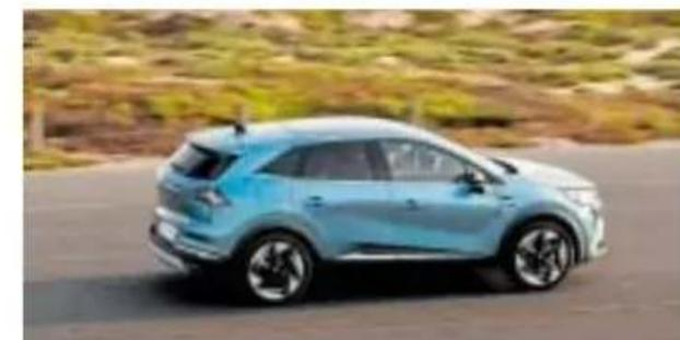
**FICHA TÉCNICA Motores:** híbrido de 140 -160 CV **Largo/ancho/alto (m):** 4,41/1,79/1,57
